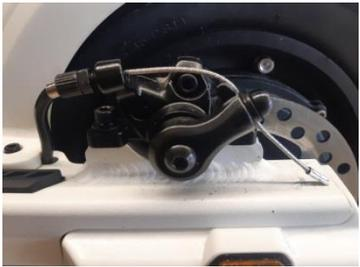
Retirer l'embout de câble situé sur l'étrier de frein, au niveau de la roue arrière.
