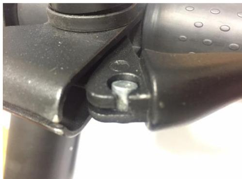
Placer l'embout du nouveau câble dans le logement du levier de frein et glisser le câble dans les gaines
