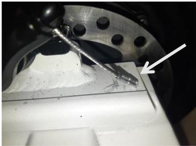
A l'aide d'une pince, saisissez l'embout et tirez vers l'arrière pour le débrancher du câble.
